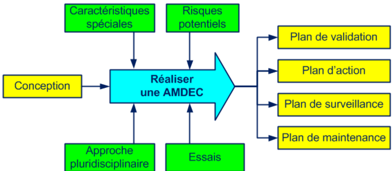
Figure 1-3. Le processus réaliser une AMDEC
